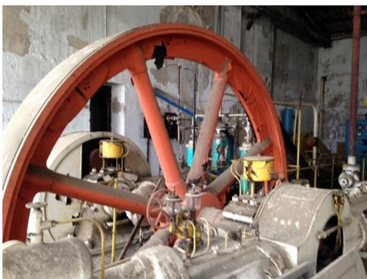
**Figura 7.5.2: Rueda que era parte de un antiguo compresor de amoníaco, utilizado para la generación de frío para el área de filtrado de cerveza. Año: Sin fecha**
